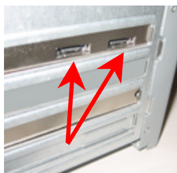
Puertos incluidos en una tarjeta eSATA instalada en una PC de escritorio
