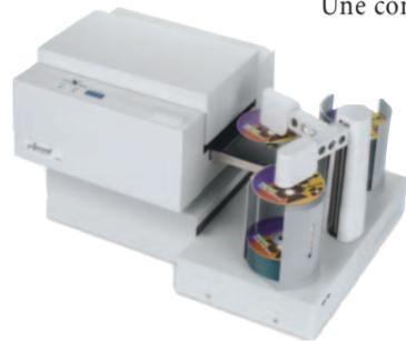
Une combinaison avec la nouvelle robotique ADL-100 permet un chargement/déchargement automatique des disques dans le tiroir de l'Accent<sup>TM</sup> jusqu'aux bacs entrant/sortant de l'Accent. Grâce à cet unique mécanisme, nous pouvons filmer automatiquement plus de 225 disques par heure.
