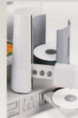
Die Rohlinge werden vom äußerst präzise konstruierten und gefertigten Roboterarm des ComposerPro in die zwei CD-R- oder DVD±R-Brenner und den optionalen Drucker geladen. Der Roboterarm greift jeden Rohling und legt ihn mit einer Positionierungsgenauigkeit von 1,5 mm in den Brenner oder den Drucker ein. Hierdurch wird die Präzision sichergestellt, die es ermöglicht, die Duplizierstation ohne Beaufsichtigung im Dauerbetrieb arbeiten zu lassen.
